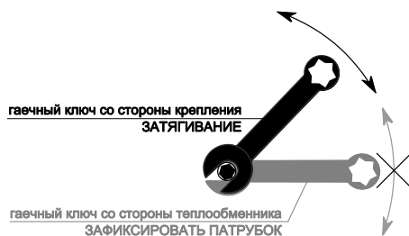
Рис. 5. Подключение к системе подачи теплоносителя
